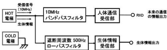
図8 生体電位測定機能付き人体通信受信機 ブロック図
